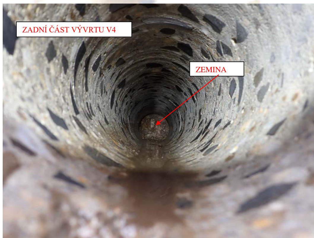
Vývrt V4 pro zjištění skladby a rozměrů PB
