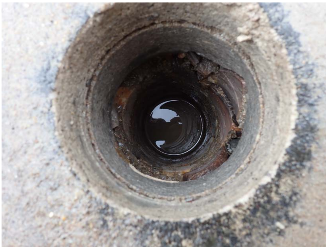
Vývrt V3 pro zjištění skladby a rozměrů PB
